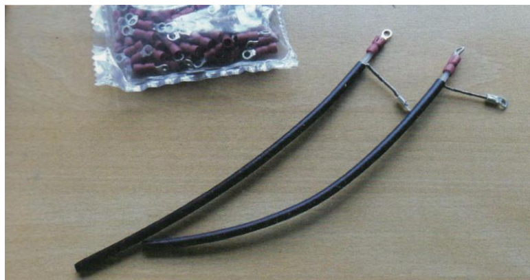
Fot. 1.3.2. Wykonanie kondensatorów koncentrycznych
