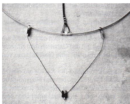
Fot. 1.7.4. Transformator delta
