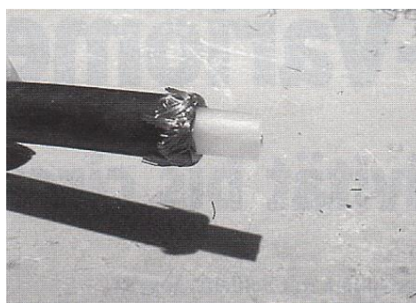
Fot. 1.7.5. Zakończenie kondensatora
