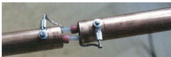
Fot. 1.3.3. Widok podłączonych kondensatorów
