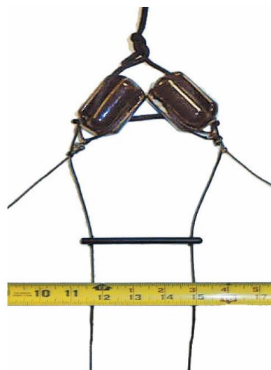
Rys. 2.7.3. Sposób podłączenia linii drabinkowej
