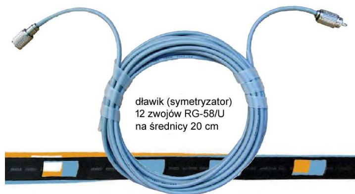
Fot. 2.4.2. Symetryzator ze zwiniętego kabla koncentrycznego
