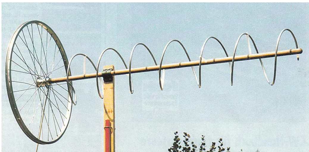
Rys. 1.10. Realizacja anteny z rys. 1.9 z reflektorem z koła rowerowego, średnica reflektora powinna być równa 0,6 \lambda lub więcej
