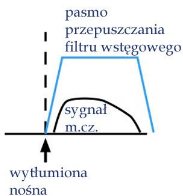
Rys. 1.3.1.2. Tworzenie sygnału jednowstęgowego w modulatorze filtrowym. Nośna jest tłumiona w modulatorze zrównoważonym, a filtr wstęgi bocznej przepuszcza tylko pożądaną wstęgę
