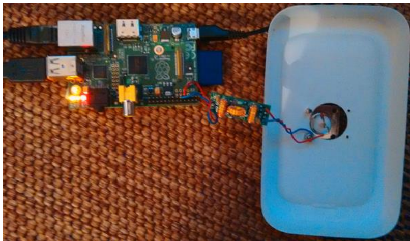
Fot. 4.2.2. Przykład konstrukcji nadajnika: od lewej do prawej kolejno Malina , filtr i obudowa z gniazdkiem antenowym.
