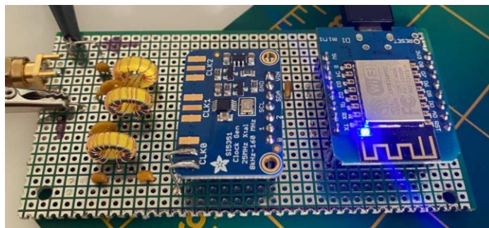
Fot. 4.1.5. Konstrukcja nadajnika WB2CBA na uniwersalnej płycie dziurkowej
