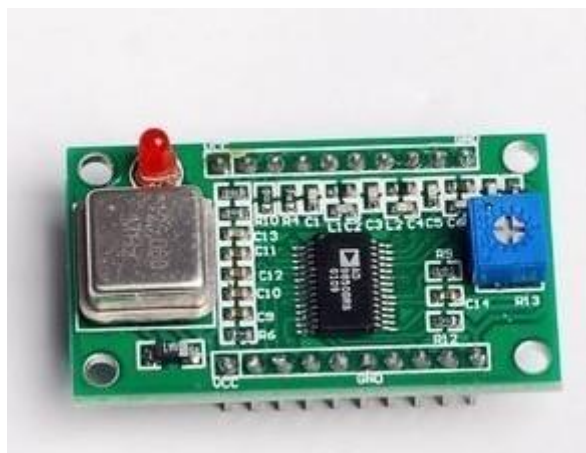
Fot. A.1.5. Chiński moduł syntezy na AD9850. W góry widoczne są kontakty równoległego złącza sterującego, a u dołu wyjścia fal sinusoidalnej i prostokątnej. Generator częstotliwości zegarowej znajduje się po lewej stronie. Do sterowania modułu można w konstrukcjach amatorskich użyć „Arduino” (temat ten poruszono szerzej w tomie 36 „Biblioteki polskiego krótkofalowca”)
