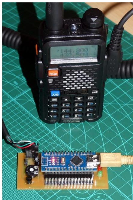
Fot. 3.1.2.2. Modem APRS podłączony do ręcznej radiostacji
