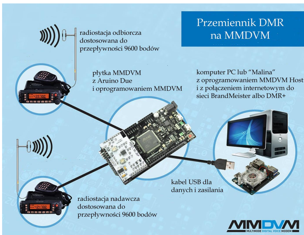
Fot. 1.10.3. Orientacyjny schemat blokowy przemiennek DMR na MMDV z radiostacjami pracującymi jako nadajnik i odbiornik i z komputerem dostępowym do Internetu
