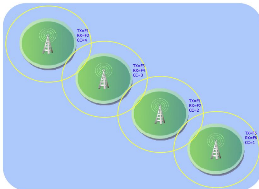
Rys. 7.1. Przykładowe rozmieszczenie przemienników na trasie ruchu stacji. Ich zasięgi częściowo zachodzą na siebie dzięki czemu możliwe jest prowadzenie łączności bez przerw. Ich częstotliwości pracy i kody CC mogą się różnić, ale wszystkie muszą pozwalać na korzystanie z jednej i tej samej grupy
