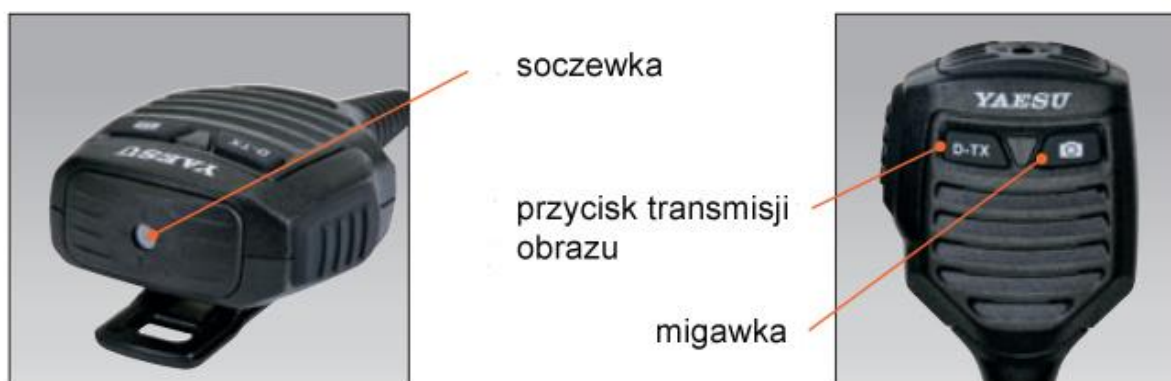
Fot. 6.1. Mikrofon MH-85A11U wyposażony w kamerę
