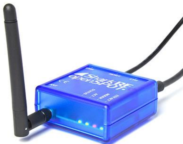
Fot. 2.2.4. „OpenSpot” i następcy pracują autonomicznie bez konieczności podłączenia do komputera. Pozwalają również na prowadzenie łączności skrótnych C4FM-DMR
