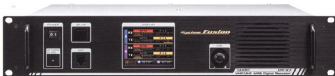
Fot. 2.4.3. Przebiennik DR-2X. Do pracy w sieci YAESU konieczny jest dodatkowy moduł LAN-01A. Moc wyjściowa jest przełączana między 50 W, 20 W i 10 W. Przebiennik jest wyposażony w funkcję automatycznego przełączania na awaryjne zasilanie z akumulatora
