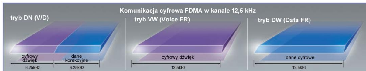
Rys. 1.2. Warianty transmisji w systemie C4FM/FDMA
