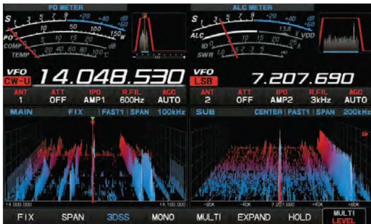
Fot. 3.4. Wskaźniki widma dla obu odbiorników (głównego i pomocniczego) równolegle. Odbiornik pomocniczy jest nastawiony na inne pasmo, inną szerokość pasma i korzysta z innej anteny. Oba widma mogą być też wyświetlane jedno nad drugim
