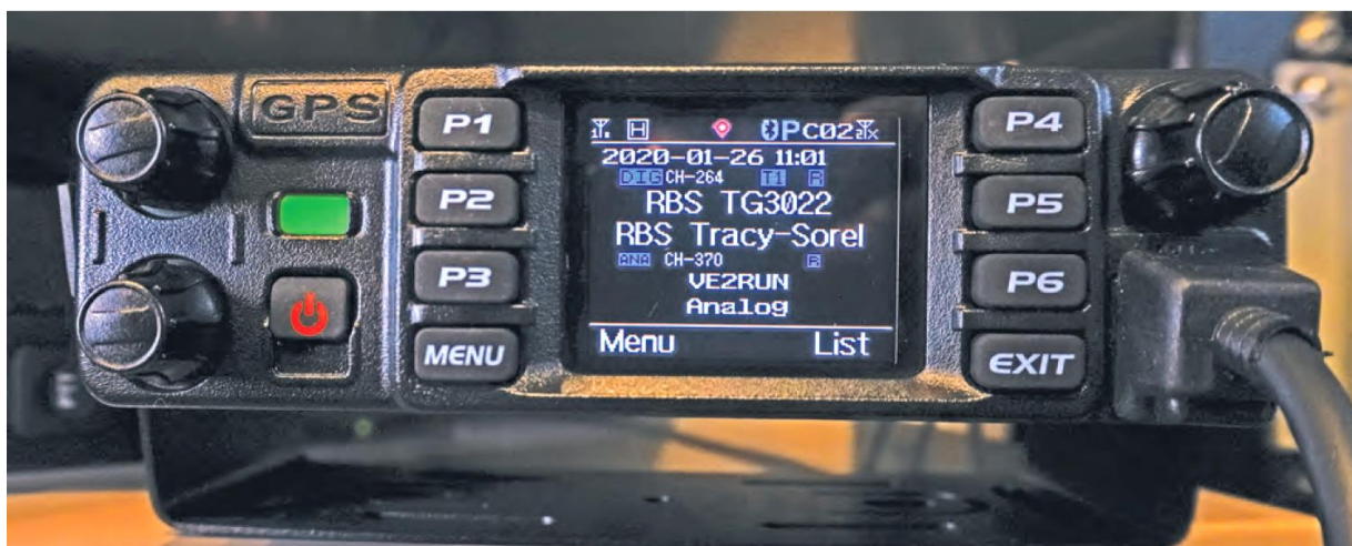
Fot. 8.1. Przednia ścianka AT-D578UVIII PRO
